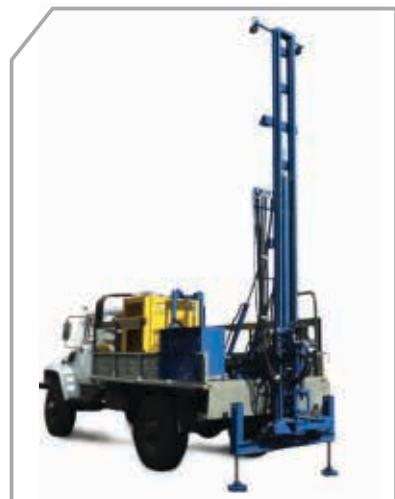
Последней разработкой в данной серии является модель «Вектор ВР-3.450». Монтаж установки на шасси ГАЗ-3308 позволил увеличить ход подачи до 4500 мм. Все без исключения модели буровых установок «Вектор ВР-3» оснащены гидронасосом и гидрораспределителями итальянского производства, доступны широкие возможности по дополнительной комплектации под индивидуальный заказ.
