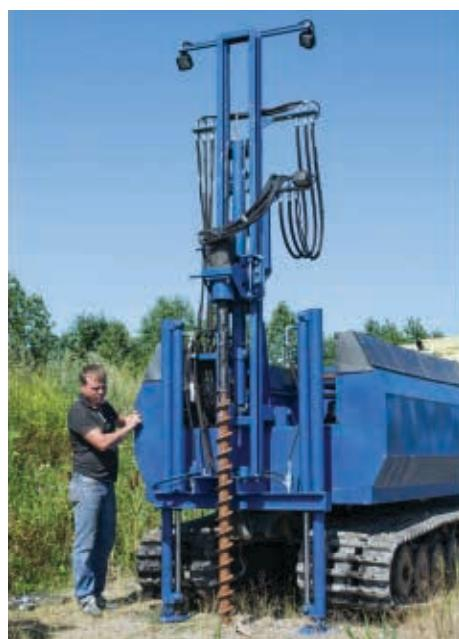
Еще больше возможностей для покорения бездорожья предоставляет монтаж «Вектор ВР-2.200» на снегоболотоход «Тундра» или вездеход BV-206 «Лось». Передвижение по пересеченной местности, болотам и водным преградам, преодоление круtyx склонов, работа в широком температурном диапазоне – все это делает установку «Вектор ВР-2.200» незаменимым помощником при проведении геологоразведки и инженерных изысканий, а также при строительстве протяженных коммуникаций.
