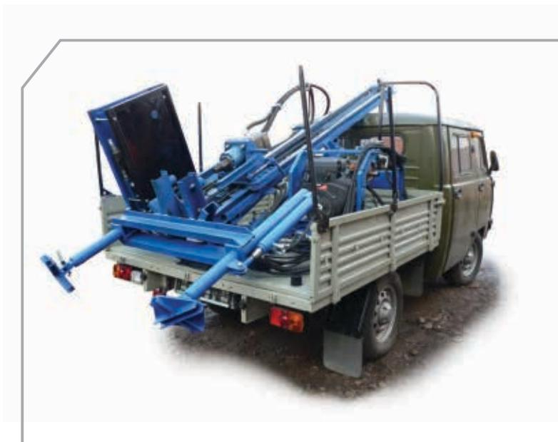
Использование в качестве шасси «легкового внедорожника» УАЗ «Фермер» позволяет преодолевать на пути к месту работ размытые участки дорог, лесные просеки и даже водные преграды глубиной до полуметра.
