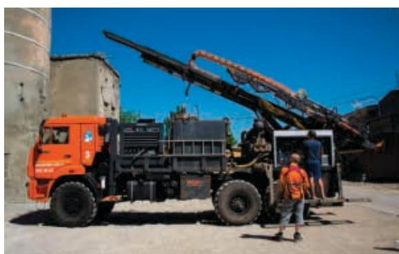
Помимо скважин на воду, установки «Вектор ВР-5» позволяют бурить разведывательные и технологические скважины, а также скважины для строительных нужд. Модели ВР-5.354 и ВР-5.520 различаются разным ходом подачи, 3540 и 5200 мм. Установленная буровая мачта прошла весь комплекс испытаний и доказала свою надежность в эксплуатации. Комфортная глубина бурения составит до 350 метров.
