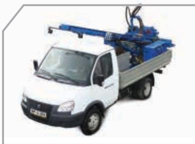
Традиционно обладателю буровых установок «Вектор» доступны несколько способов бурения: колонковое, шнековое, с использованием пневмоударников, бурение с промывкой технологическим раствором либо с продувкой воздухом. Монтируется установка «Вектор ВР-3» на колесное шасси автомобилей УАЗ, ГАЗ, Газель, а так же вездеходную гусеничную технику.
