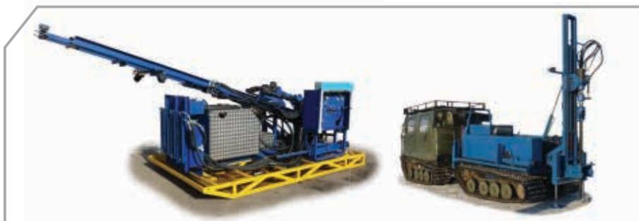
Они способны проводить буровые работы при экстремально низких температурах (до -50° С), что особенно актуально для условий российского Севера, Сибири и Дальнего Востока. Монтаж на вездеходное шасси обеспечивает установке повышенную проходимость при инженерно-геологических изысканиях и бурении разведочных скважин.
