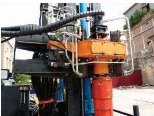
Установки «СВР-4.200» и «СВР-4.354» оснащены итальянским гидравлическим оборудованием. Основная разница между двумя этими моделями – разный ход двухскоростного вращателя (2000 мм и 3540 мм соответственно). Подача вращателя происходит при помощи гидроцилиндра с полиспастной системой.
